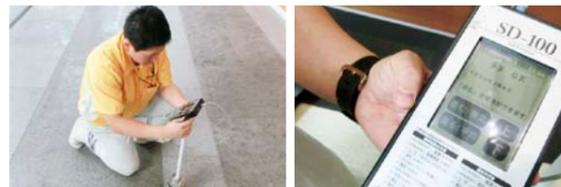
汚染度計(汚染を数値化する機器)を使用した清掃インスペクション
