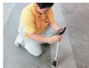
清掃インスペクション(汚染度計使用)
